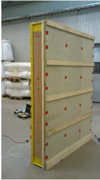
Foto 1 Provrigen med utvändigt vindsydd av pressad mineralullsboard. En vertikal skarv vid en lättbalk fanns i boardskivan. Ingen tätning företogs av boarden i sida vilket kan antas ge ett något större luftläckage än i verkligheten.
