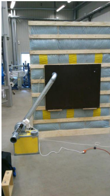
Foto 2 Invändig låda för tryckhållning monterad på insida glesläkt och PE-folie.
